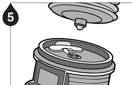
5 Comprimer la cartouche de graisse jusqu'à ce que du lubrifiant s'en écoule.
